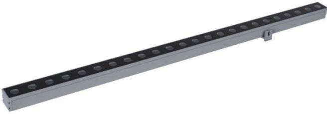
Bañador de pared Lavov de la familia WALLLIGHT (OW02) con una potencia de 72W y una distribución luminosa de 10°X60° con un flujo luminoso real de 2500lm y una eficacia luminosa de 34,72lm/W con una temperatura de color CCT de RGB 3 in 1K, fabricado en aluminio extruido, tapas de aluminio inyectado a presión, cubierta de cristal templado y acabado en color Gris. Do not include driver.
