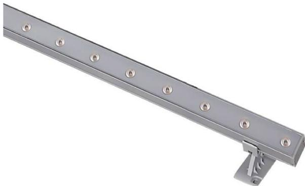
Bañador de pared Lavov de la familia WALLLIGHT con una potencia de 7,3W y una optica de 30 grados. Con un flujo luminoso real de 510lm y una eficacia luminosa de 69,86lm/W. Temperatura de color de 3000. Fabricado en aluminio extruido y tapas finales de aluminio inyectado a presion, cubierta de cristal templado y acabado en color gris .Driver incluido. Driver ON-OFF
