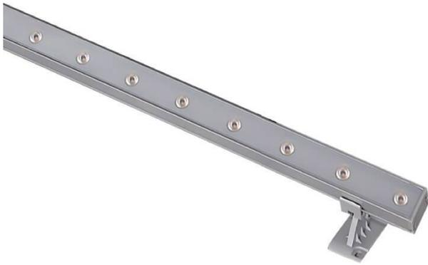
Bañador de pared Lavov de la familia WALLLIGHT con una potencia de 14,7W y una optica de 40 grados. Con un flujo luminoso real de 1020lm y una eficacia luminosa de 69,39lm/W. Temperatura de color de 3000. Fabricado en aluminio extruido y tapas finales de aluminio inyectado a presión, cubierta de cristal templado y acabado en color gris .Driver incluido. Driver ON-OFF
